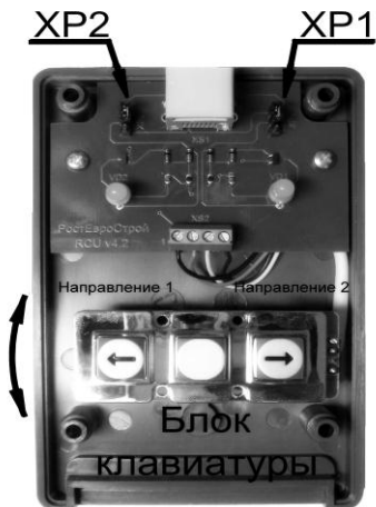
Вид пульты со снятой крышкой
