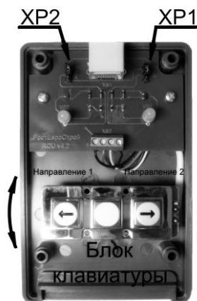
Вид пульта со снятой крышкой
