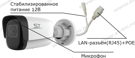
Рис.1 Схема подключения видеокмеры
